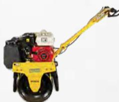
Vibrocompactador de rodillo simple m/ gasolina Honda
